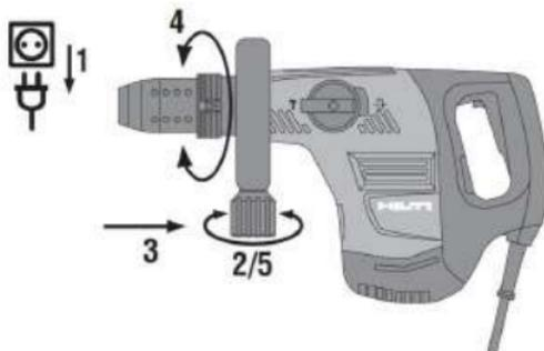
1. Deslice el soporte (banda de sujeción) y la empuñadura lateral desde delante a través del portaútiles hasta la ranura prevista para ello.
