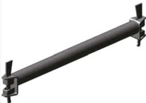
Constituyen la estructura horizontal del andamio. En sus dos extremos lleva soldados cabezales de unión en los cuales están alojadas las cuñas. Sirve además como baranda de protección y como apoyo a las plataformas. Están fabricados en tubería estructural (ASTM A 500 Grado C) de 48 mm de diámetro y 2.5 mm de espesor.
