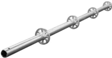
Forma la estructura vertical del andamio, acoplándose uno sobre otro para ganar altura. Cada 50 centímetros, se ubica una roseta de 8 acoples, lo que facilita un montaje seguro y rápido.
