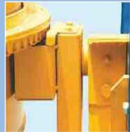
Detailed gear protection system. Detalle de sistema de protección de engranajes.
